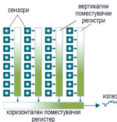
Сл. 3.14: Архитектурата на ILT-CCD сензор
