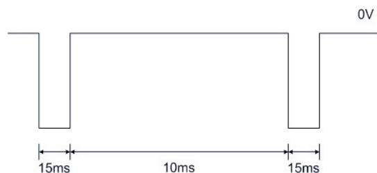
Сл. 6.11: Импулсен напон на анодите од дисплејот A_1 и A_2
