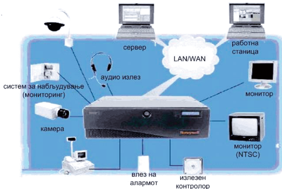
Сл.12.7: Опрема и врски на CCTV систем-ТВ во затворен круг
