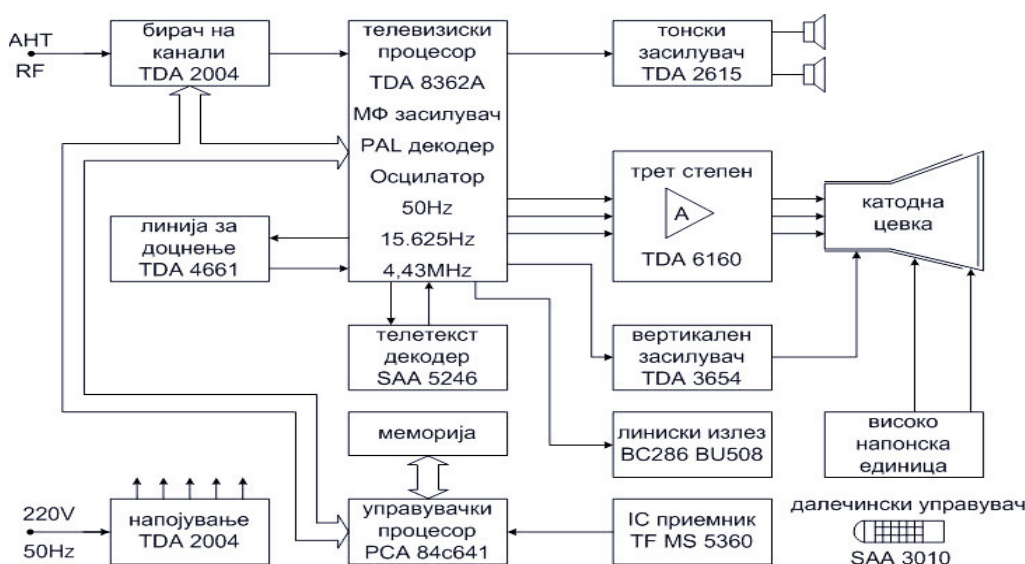
Сл.7.14: Блок-шема на ТВ-приемник со шасија B100
