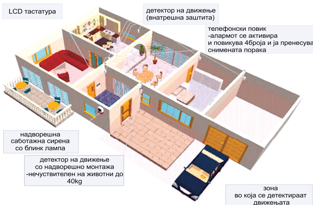
Сл.6.17: Обезбедување на куќа со алармен систем против грабежи
