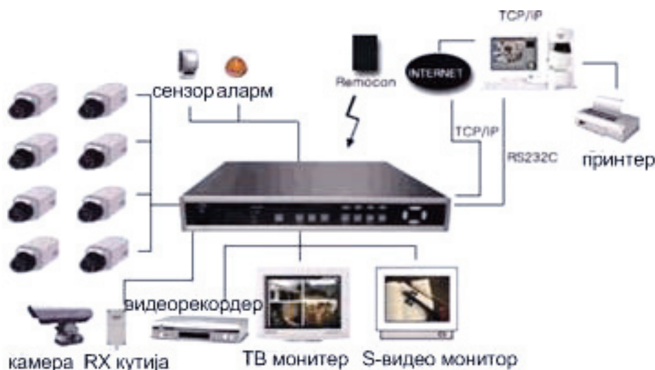
Сл.6.3: Уреди и заемни врски во интегриран систем за набљудување
