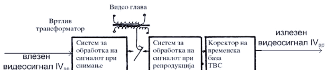
Сл. 10.5: Блок-шема за обработка на видеосигналот
