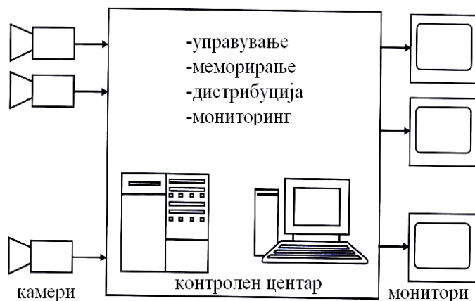
Сл.12.6: Блок-шема на систем за интерна телевизија
