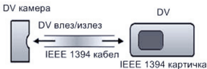
Сл.3.9: Поврзување на DV камера со компјутерска картичка
