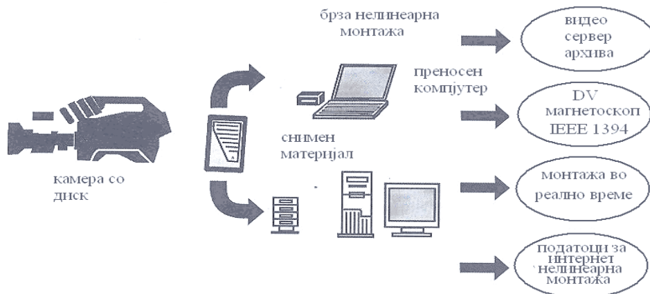
Сл.11.27: Систем користен за нелинеарна монтажа
