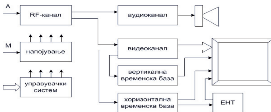
Сл. 6.1: Општа блок-шема на ТВ-приемник
