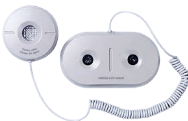
Сл.6.13: Ултразвучни сензори за движење и детектор на движење
