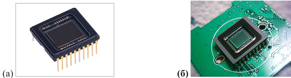
Сл.3.8: CCD сензори (а), CMOS сензори (б)
