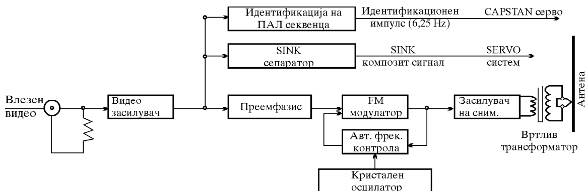
Сл.10.8: Блок-шема на систем за обработка на видеосигнал при снимање
