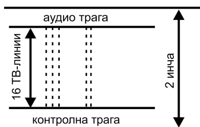
Сл.10.4: Трансверзално запишување на видеоинформација со нормално движење на главата преку лентата
